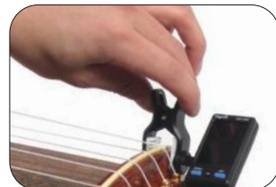
② チューナー(別売り)を用意しセットする。(写真はクリップ式チューナーを使用。)
